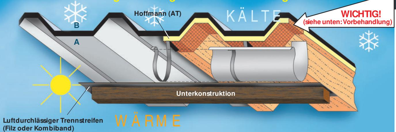
Das Trapezblech ist auf der Innenseite A mit einem Faservlies als Kondensationsregulator beschichtet. Die kondensierte Feuchtigkeit wird durch dieses Vlies aufgenommen und verdunstet anschliessend, wenn die Temperatur steigt. Die Beschichtung dämmt das Geräusch von auftreffenden Regentropfen und Hagel um ca. 12 %.
